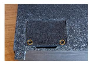
Schritt 2: Stecke die SD-Karte in den Port der Platine und schließe die Serviceklappe wieder.
