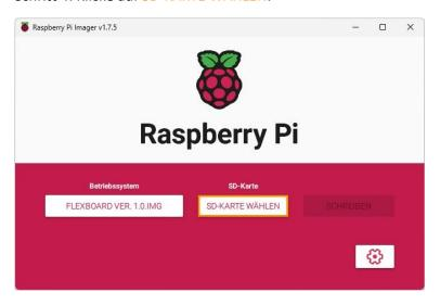
Schritt 5: Wähle das Laufwerk "MXT-USB Storage Device USB Device – 8.0 GB", wo sich die SD-Karte befindet.
